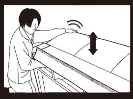
その際に、背部分を上下に少しずつずらし、 ネジ穴の位置を確認しながら調節して いただくと、取り付けやすくなります。
