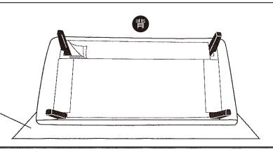
2. 下図の ( ) で囲まれた 部分のボルト (4箇所)を 外します。
